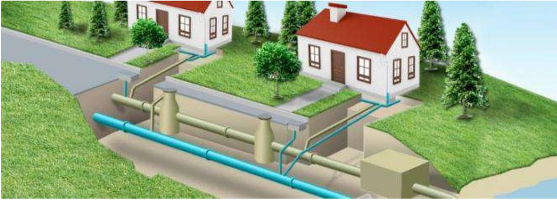
***Рис.41. Схема прокладки водопровода и водоотведения в разрезе***
