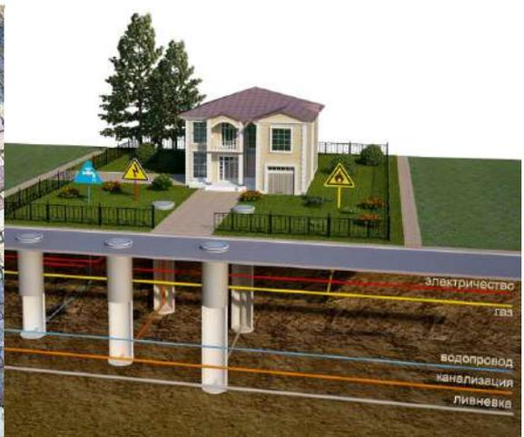
*Рис.40. Схема прокладки инженерных сетей в разрезе*
