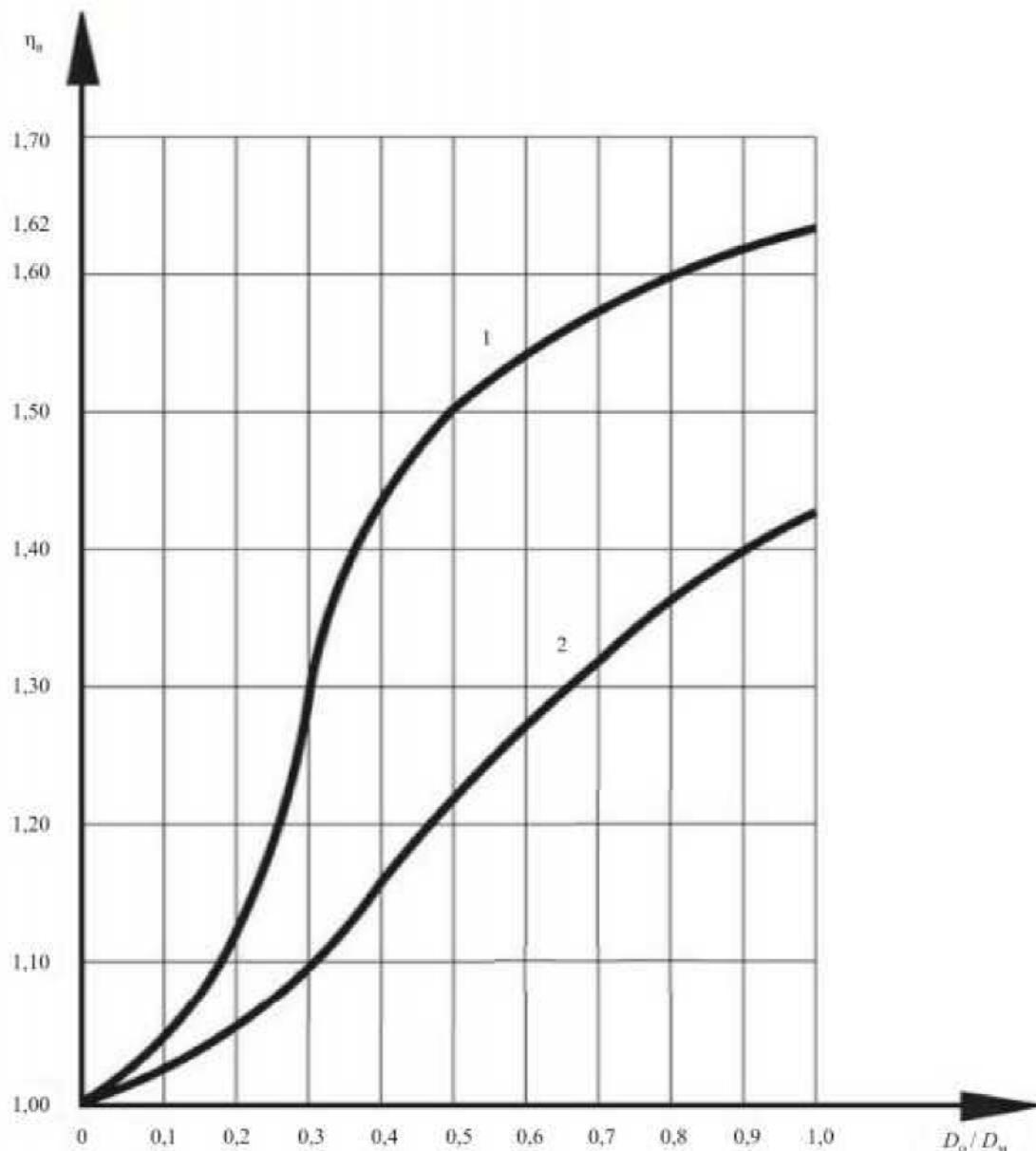
$\eta_b$  – коэффициент несущей способности деталей;  $D_o/D_m$  – отношение наружного диаметра ответвления тройника к наружному диаметру основной трубы тройника
