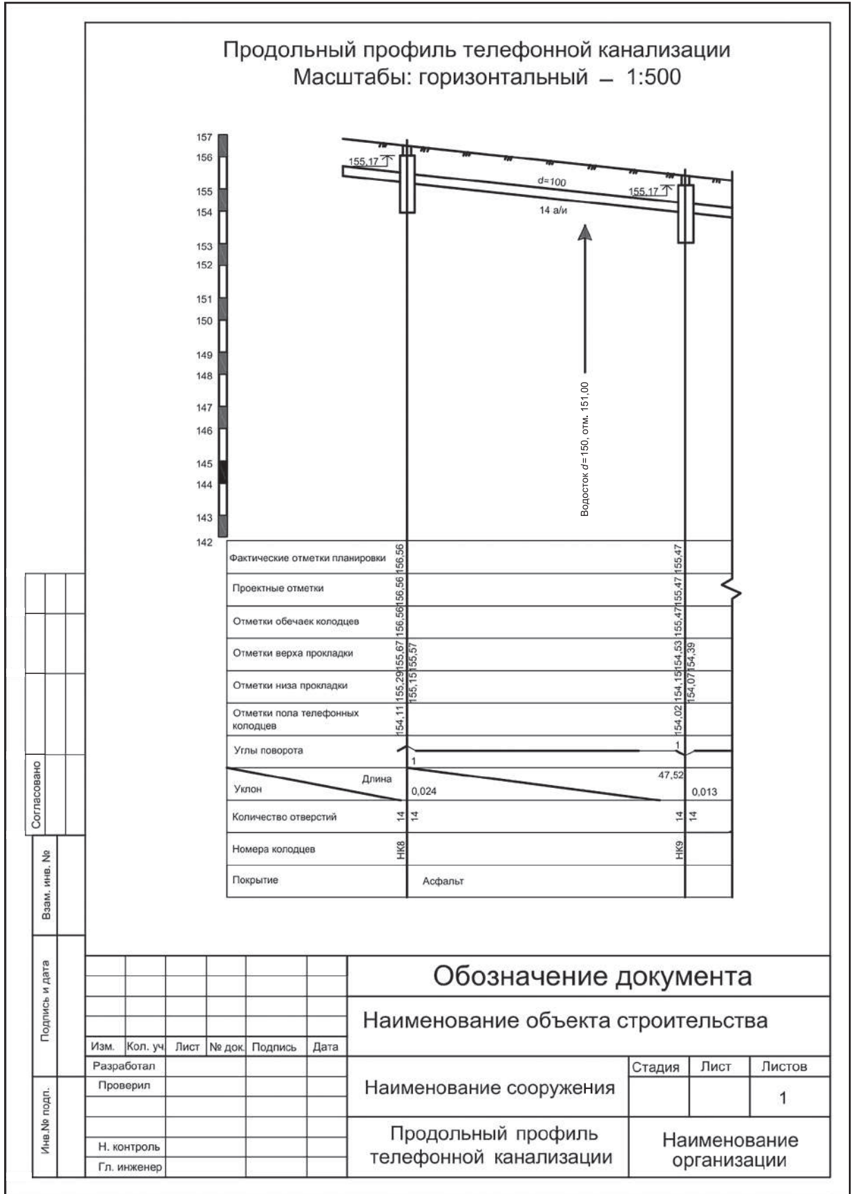
Рисунок Д.3 — Исполнительный чертеж телефонной канализации. Профиль
