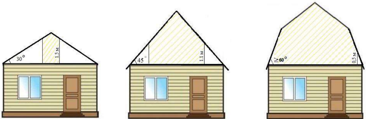
Рис. 10. Определение площади мансардного этажа нежилого здания
