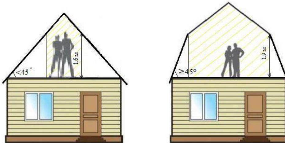
**Рис. 11а. Определение площади мансардного этажа жилого здания**
